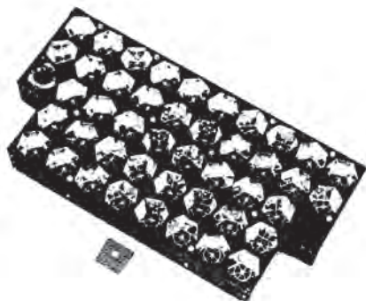
NTS-2 laser reflector. (Buisson-1977, p. 194)
